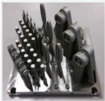
Musterbauteile mit Stützstrukturen werden vollautomatisch bearbeitet. (Bildquelle: Loll)
